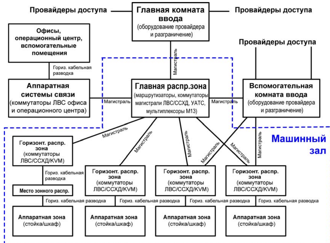
Рис. 5. Пример распределённой топологии дата-центра с несколькими комнатами
