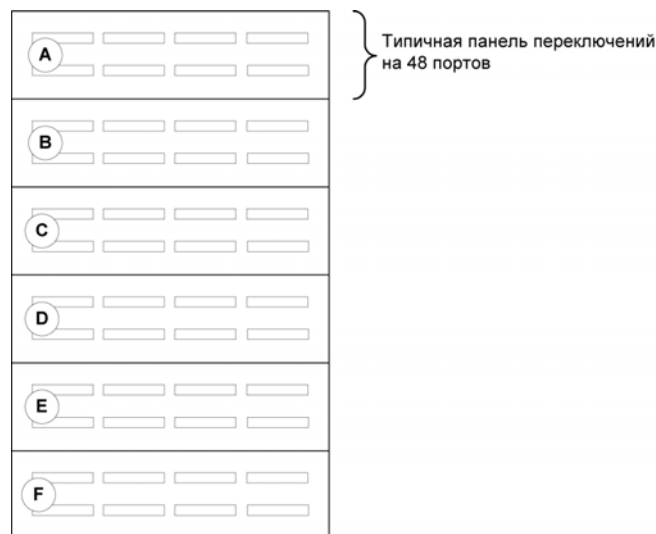
Рис. 13. Пример идентификационной схемы для панели переключений медной кабельной разводки
