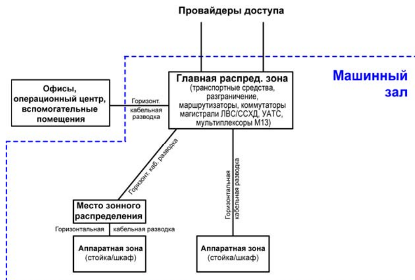
Рис. 4. Пример редуцированной топологии дата-центра
