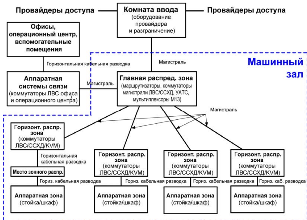
Рис. 3. Пример базовой топологии дата-центра
