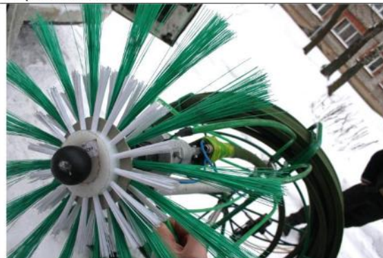
Foto 4. Tīrīšanas iekārta ar birsti, paredzēta ventilācijas kanālu tīrīšanai.
